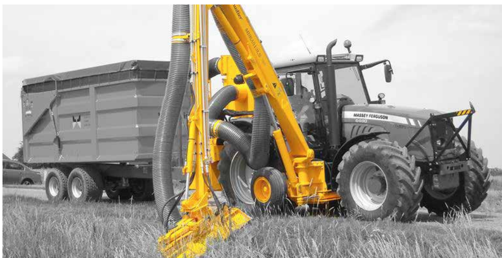
Figur 6.1. Klippaggregat med pneumatisk uppsugning och insamlingscontainer. Med tillstånd från Herder BV.
