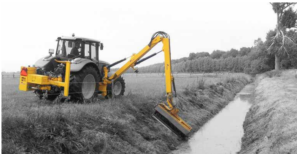
Figur 6.2. Klippaggregat på rörlig arm ca 7 m lång. Med tillstånd från Herder BV.
